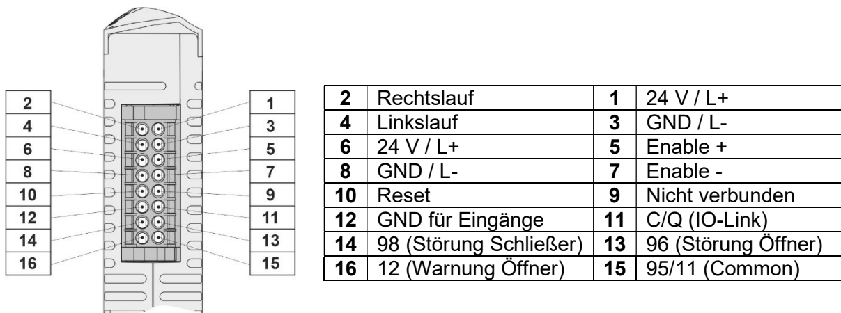
Bild 8 Steckverbinder Steuerleitungen – 3~ Konfiguration
