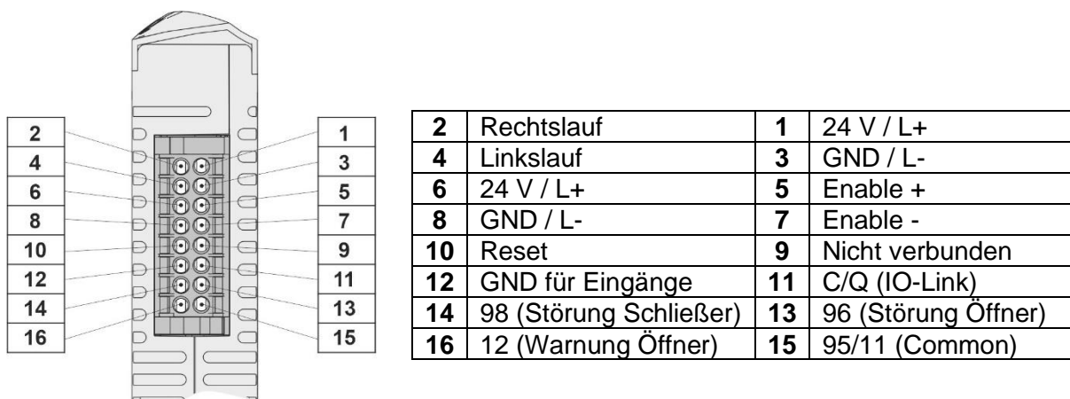
Bild 8 Steckverbinder Steuerleitungen – 3~ Konfiguration
