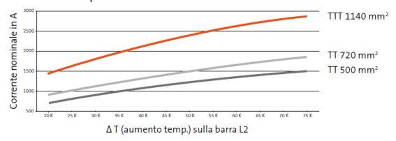
Per un corretto dimensionamento delle barre in accordo con la norma IEC/EN 61439-1 é necessario considerare la massima sovvratemperatura raggiungibile dalle barre stesse.
