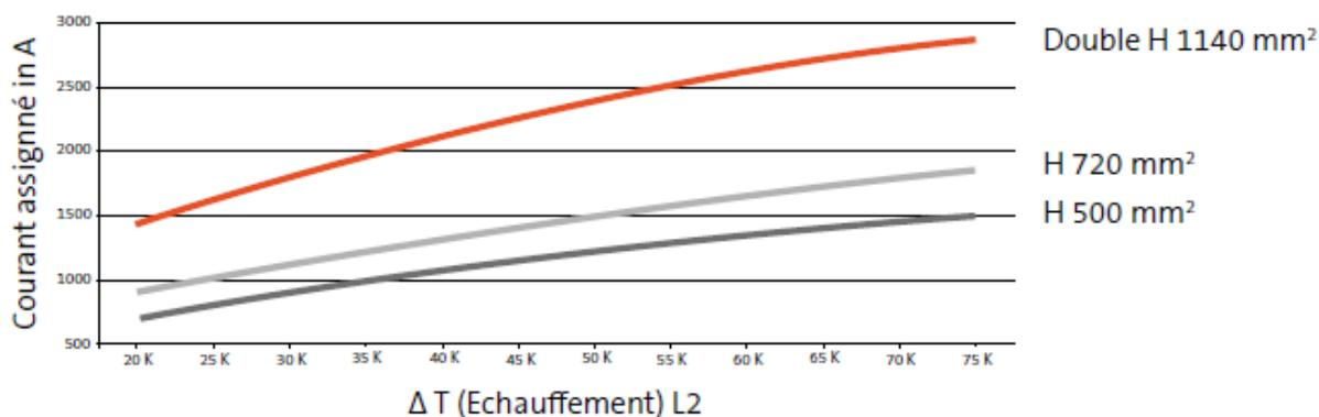
Les limites d'échauffement sont définies conformément à la DIN IEC/EN 61439-1.
