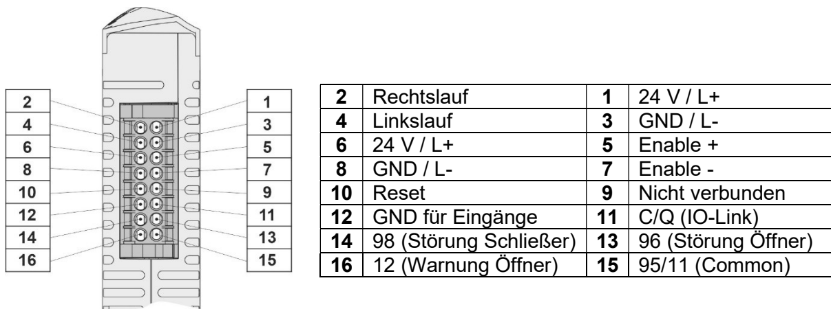
Bild 8 Steckverbinder Steuerleitungen – 3~ Konfiguration
