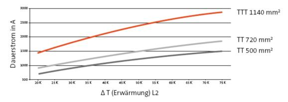
Bei Nachweisführung gemäß IEC/EN 61439-1 ist die maximale Erwärmung der Sammelschienen zu berücksichtigen.
